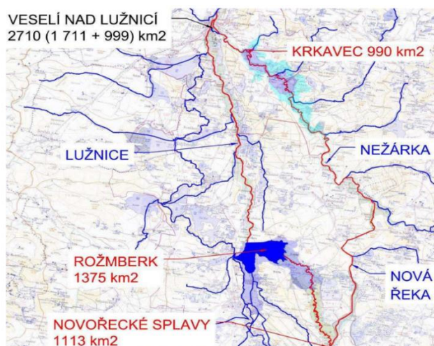
Obr. 1: Vodohospodářský uzel Lužnice – Nová řeka – Nežárka s uvedenými plochami povodí. Nádrž v profilu jezu Krkavec na Nežárce nebyla vystavěna. Zdroj: VU [online]
