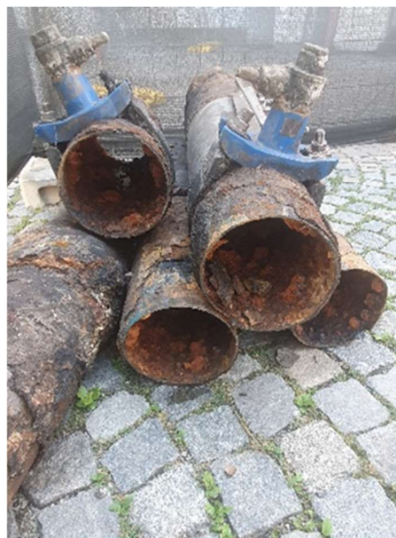
Obr. 5. Odstraněné ocelové vodovodní potrubí
