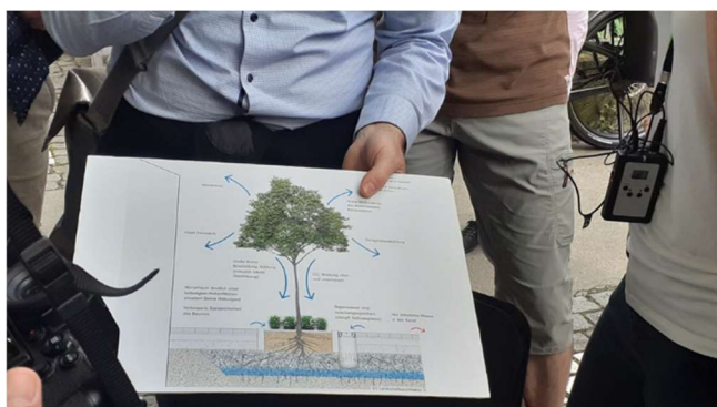
Obr. 34. Ukázka zavlažení stromu osazeného ve strukturálním substrátu ve vídeňské čtvrti Aspern (Arch. Daniel Zimmermann), 2024
