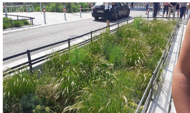
Obr. 7. Vsakovací štěrkový záhon – průleh ve vídeňské čtvrti Aspern
