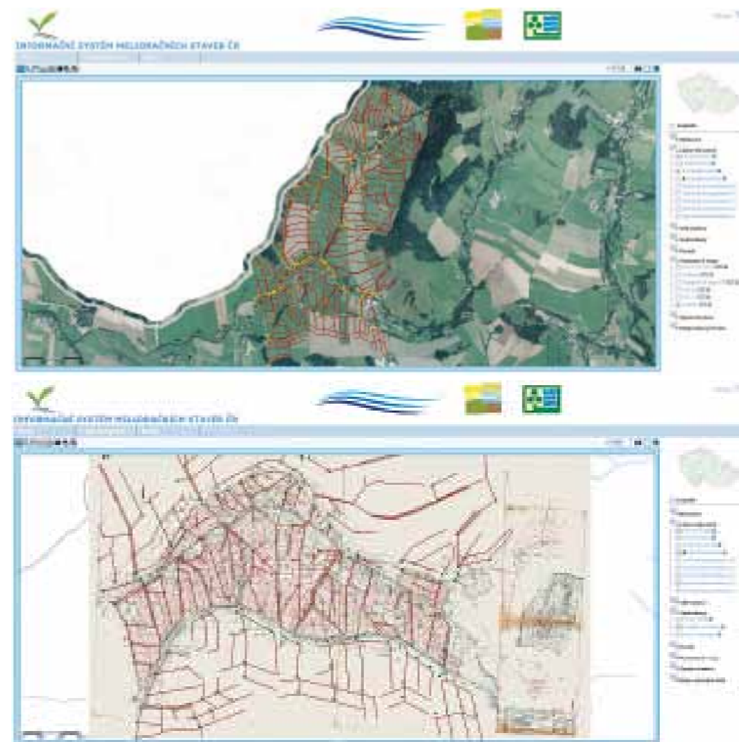
Obr. 3 a (nahore): Příklad zpracování uživatelského rozhraní ISMS (verze 2016) pro Lipkovský potok v povodí Tiché Orlice. 3b (dole): Georeferencovaná situace (přehledná nebo podrobná) se zvýrazněním tras trubních HOZ.
