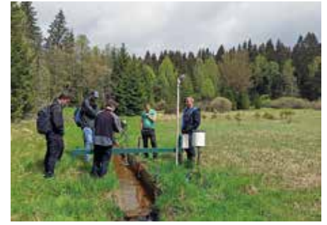
Obr. 4. Přeliv na toku z lesního povodí Bukového potoka při výuce hydrometrování
