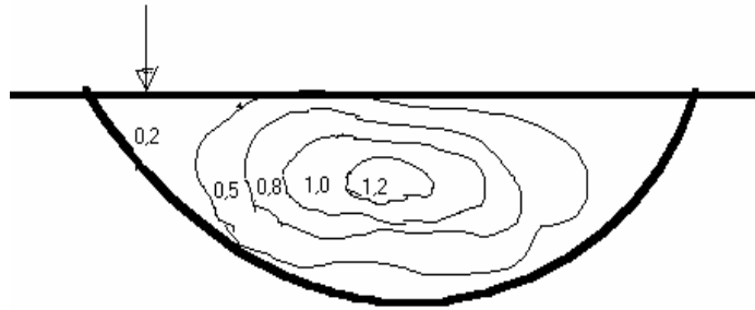
Obr. 3.17 : Rychlost v profilu toku, izotachy
