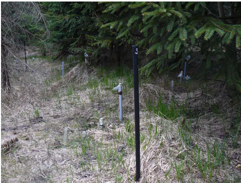
Obr. 2: Experimentální ploška "Nad cestou" s tenzometry a jehlovými vrty – příprava na zimu.
