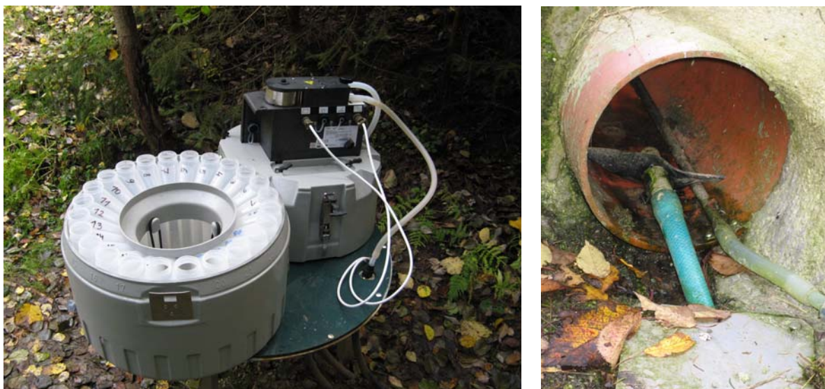
Obr. 2 a, b: Automatický vzorkovač ISCO: a) foto přístroje, b) odběr vody z drenážní výusti.
