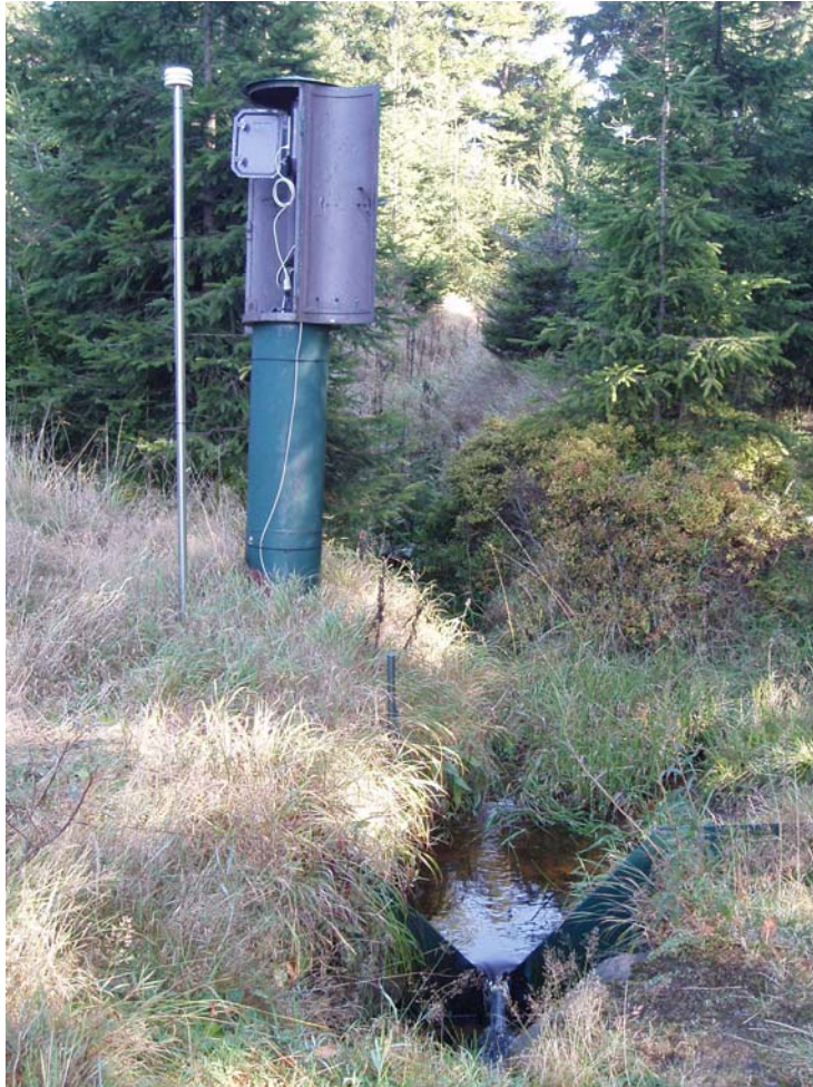
Obr. 1: Měrný přepad s úhlem 90^\circ na povodí U Dvou louček.
