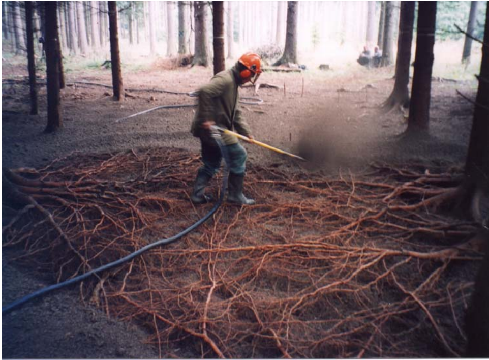
Obr. 6: Postup práce při odkryvu kořenů smrku pomocí supersonického proudu vzduchu.
