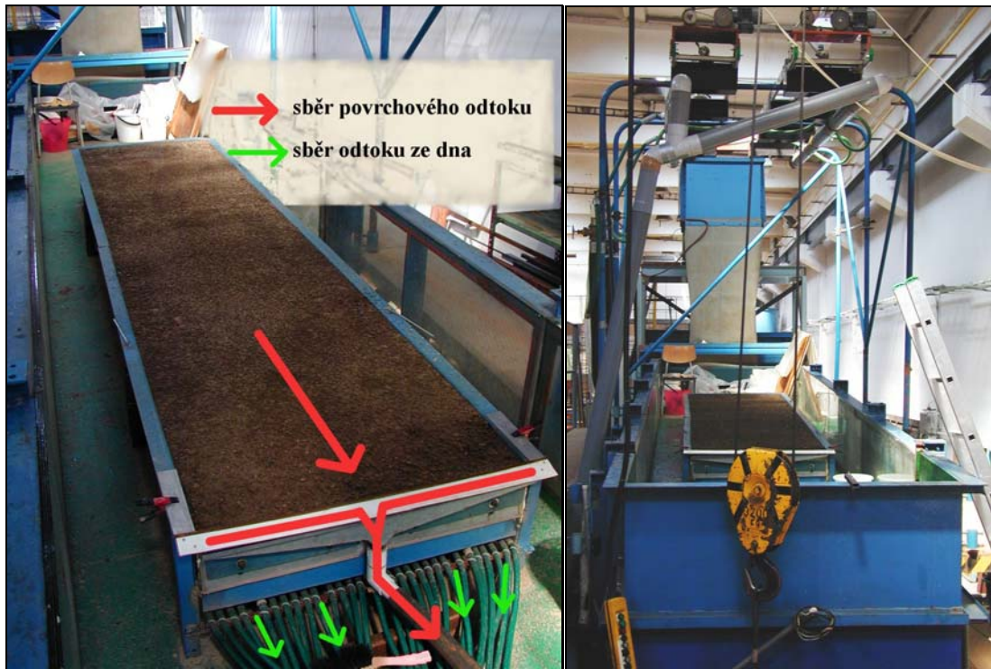
Obr. 1: Pohled na zemní vzorek (vlevo) a celkový pohled na experimentální žlab (vpravo)
