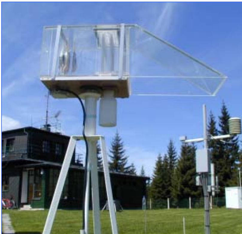
Aktivní a pasivní mlhoměr na stanici Churáňov (1123 m n.m. a povodí Liz (0,99 km 2 , 828 – 1074 m n.m.).
