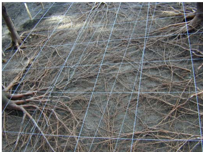
Obr. 7: Příklad kořenových systémů souboru smrků odkrytých supersonickým proudem vzduchu (odkryv plochy přes 65 \text{ m}^2 do hloubky 30-40 cm, pomístně do 70 cm, trval 6 hodin).
