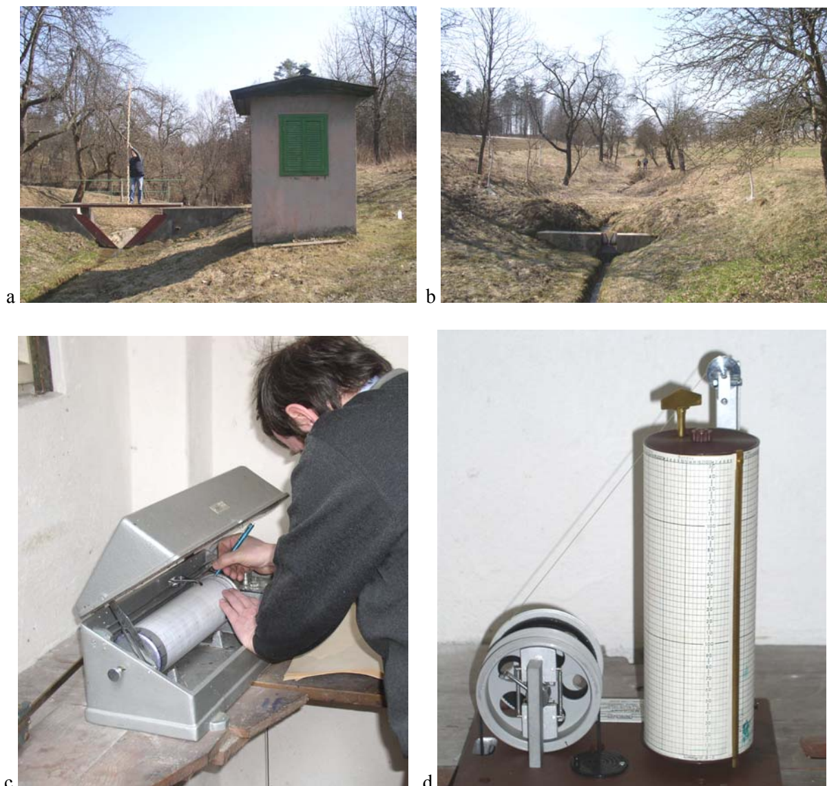
Obr. 2 Poľnohospodársky využívané mikropovodie Rybárik, a,b) merné prípady Thompson, c) merná búdka s limnigrafom Valdaj, apríl 2005; d) vpravo – merná búdka s limnigrafom s týždenným chodom, od júna 2005. (Foto - Pekárová, 5.4. 2005).
