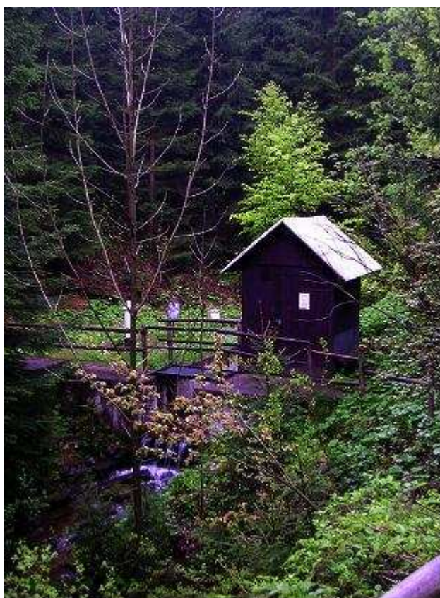
Foto 3 Měrný žlab, limnigrafická budka a pluviograf na povodí Červík podpovodí A.
