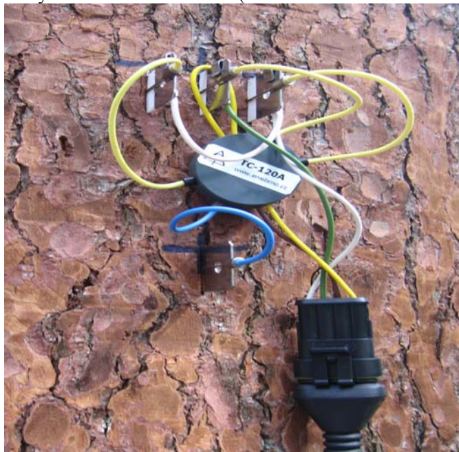
Obr. 1: Čidlo pro měření transpiračního proudu metodou deformace tepelné bilance kmene (THB) instalované z protilehlých stran kmene stromu.
