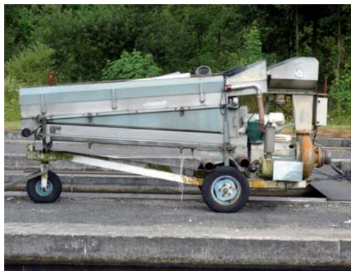
Třídíčka lososovitých ryb (Pd, Si)
